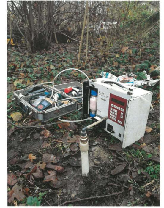
Foto 4: Probenahme Bodenluft an T2-2
