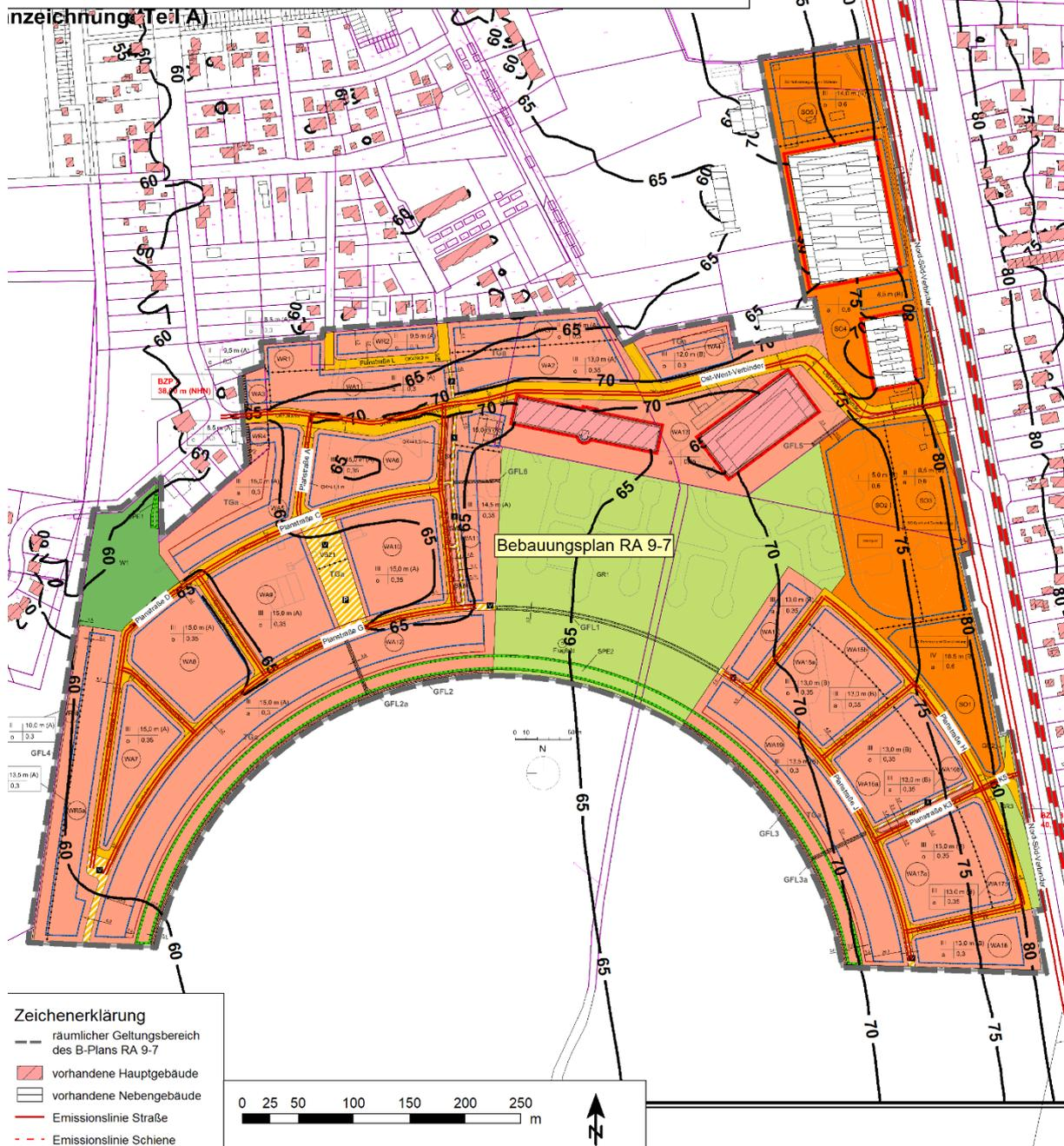
Abbildung 34: Beurteilungspegel Tag-Wert bei freier Schallausbreitung Büro ALP 03/2021<sup>30</sup>
