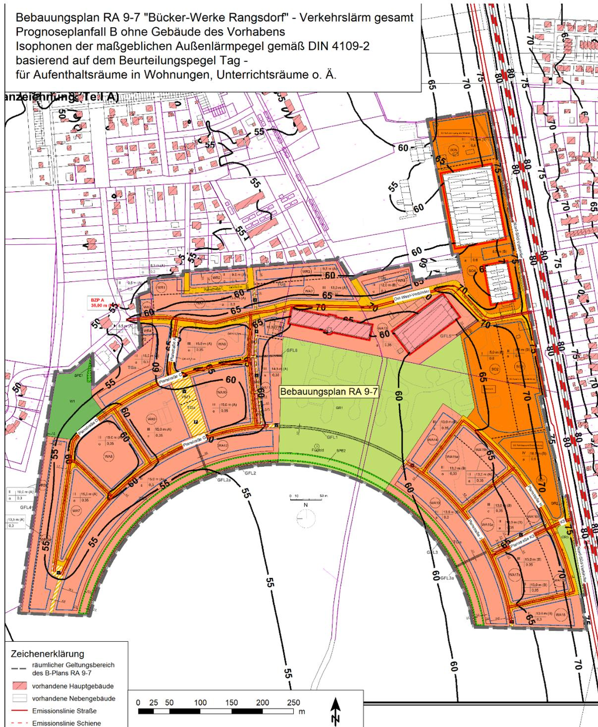
Abbildung 33: Beurteilungspegel Tag-Wert bei freier Schallausbreitung Büro ALP 03/2021<sup>29</sup>
