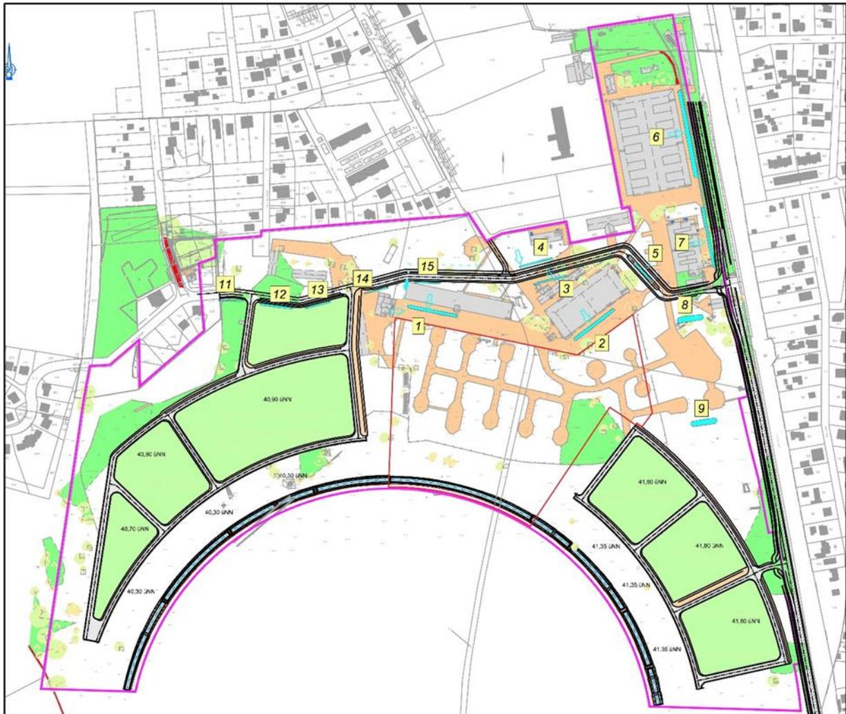
Abbildung 30: Dezentrale Mulden-/ Rigolenelemente im Norden
