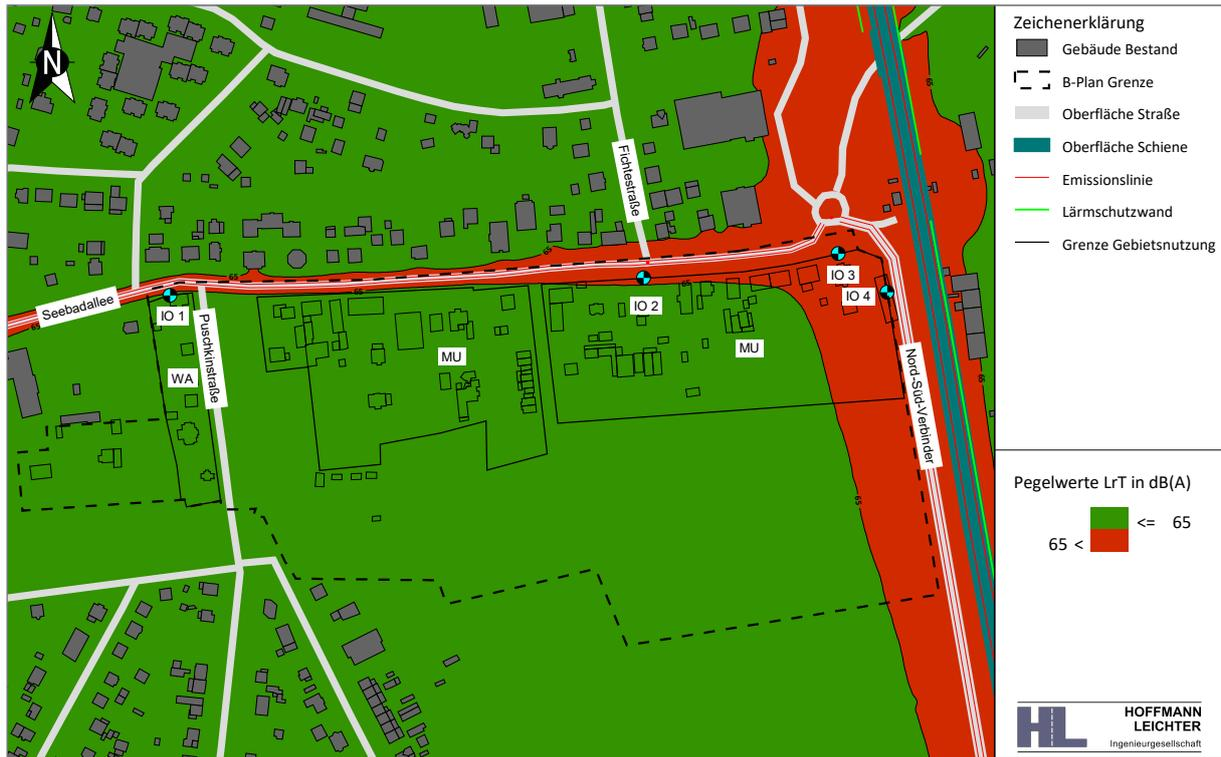
**Abbildung 8** Isophonenkarte in 8 m Höhe über Gelände | Beurteilung nach DIN 18005 | 06:00 - 22:00 Uhr | Überschreitung des Immissionswerts für Außenwohnbereiche
