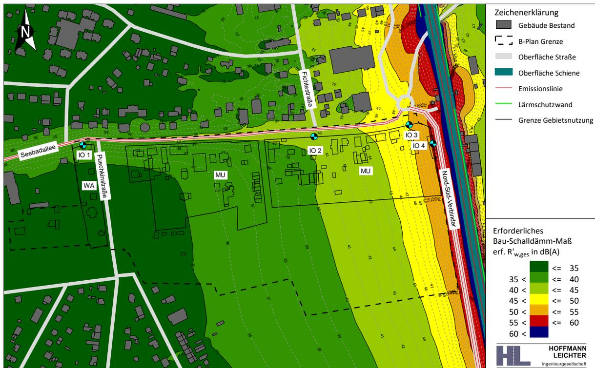
**Abbildung 11** Erforderliches gesamtes bewertetes Bau-Schalldämm-Maß gemäß DIN 4109 | Aufenthaltsräume in Wohnungen u. Ä.
