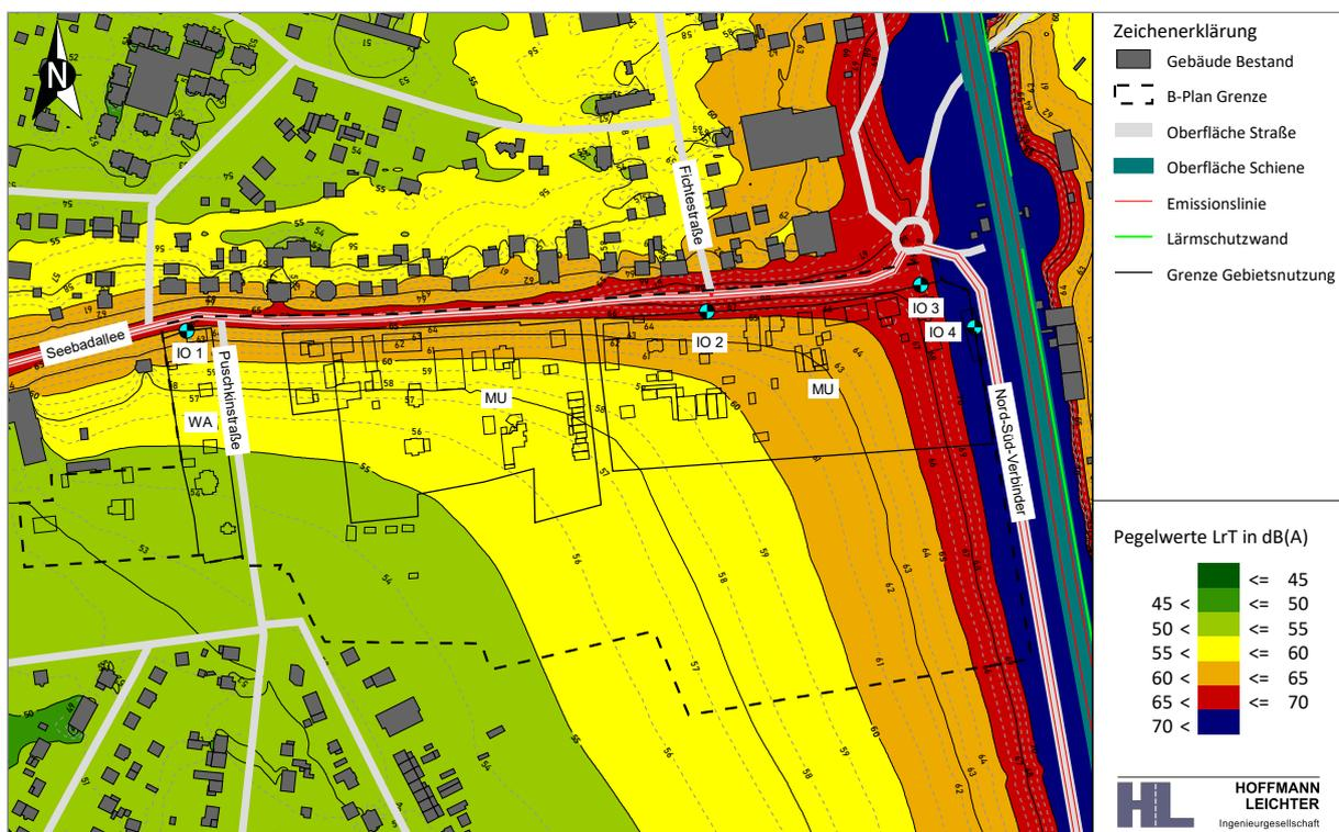
Abbildung 4 Isophonenkarte in 8 m Höhe über Gelände | Beurteilung nach DIN 18005 | 06:00 - 22:00 Uhr
