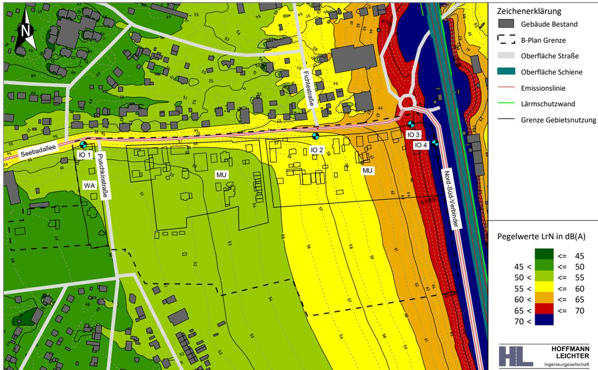
Abbildung 5 Isophonenkarte in 8 m Höhe über Gelände | Beurteilung nach DIN 18005 | 22:00 - 06:00 Uhr
