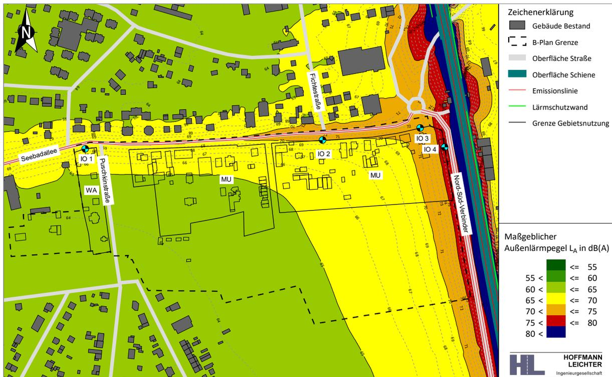
Abbildung 10 Maßgeblicher Außenlärmpegel gemäß DIN 4109 | Büroräume u. Ä.
