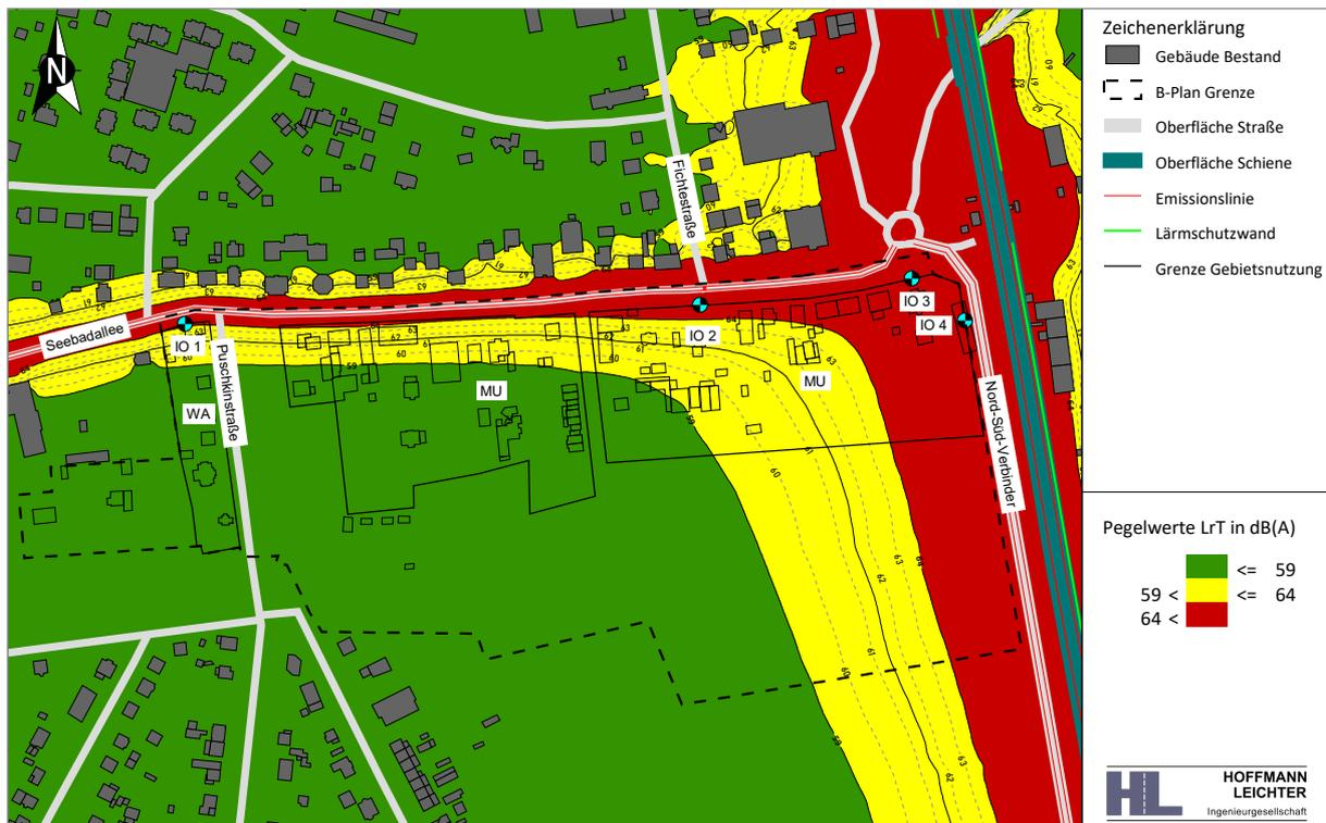
**Abbildung 6** Isophonenkarte in 8 m Höhe über Gelände | Beurteilung nach 16. BImSchV | 06:00 - 22:00 Uhr
