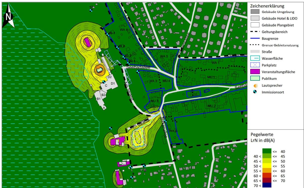
Abbildung 15 Isophonenkarte in 5 m Höhe über Gelände | Beurteilung nach Freizeitlärm-Richtlinie | nachts, 22:00 - 06:00 Uhr | Schallschutzmaßnahmen
