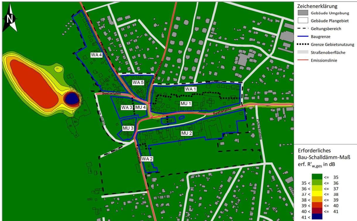
Abbildung 24 Erforderliches gesamtes bewertetes Bau-Schalldämm-Maß gemäß DIN 4109 | Büroräume u. Ä.
